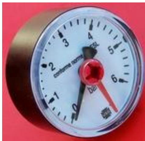
169. ábra Nyomásmérő elvi vázlata és képe
